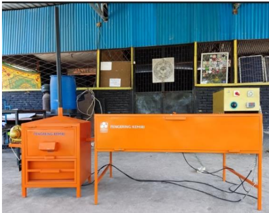
Gambar 3b. Mesin Pengering Kemiri Bahan Bakar Biomassa
