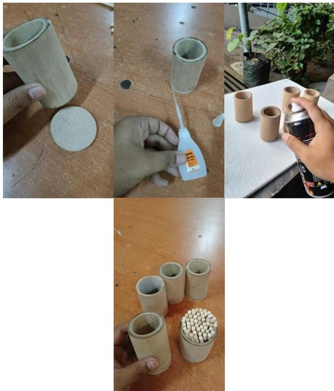
Gambar 6. Tahapan Pembuatan Komponen Wadah Bambu (2)
