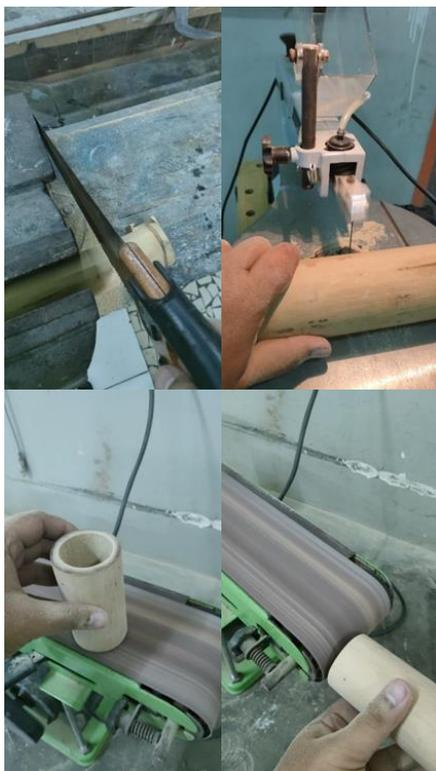
Gambar 5. Tahapan pembuatan komponen wadah bambu (1)
